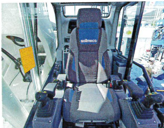
最新型キャブ 幅 1050mm で窓が大きく 視界が広い
